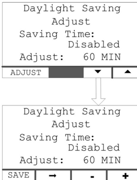
**FIGURE 28. "DAYLIGHT SAVING ADJUST SAVING TIME" SCREEN NAVIGATION**
