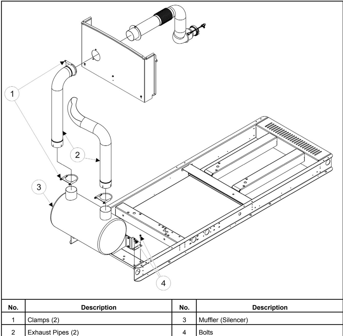
FIGURE 56. MUFFLER INSTALLATION
