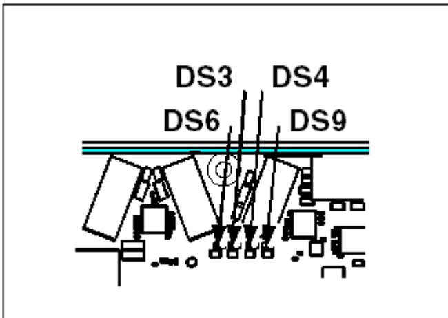
**FIGURE 34. PCC BASE BOARD LEDS**
