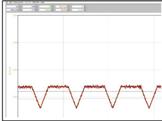
**FIGURE 80. GOOD FUEL CONTROL EXAMPLE**
