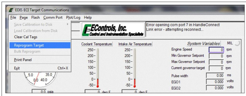
FIGURE 22. PULL DOWN REPROGRAM TARGET SELECTION
