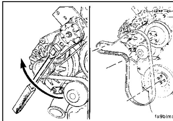
**FIGURE 75. INSTALL THE DRIVE BELT**
