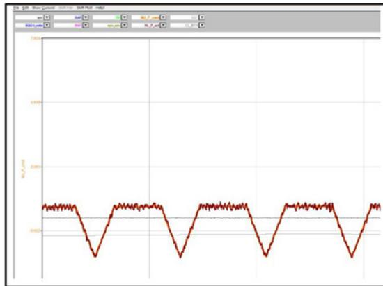
**FIGURE 78. GOOD FUEL CONTROL EXAMPLE**
