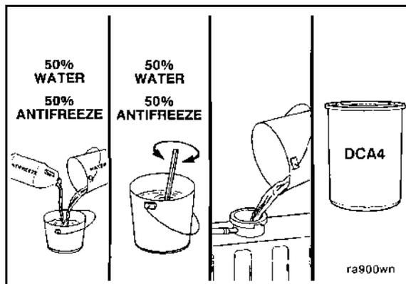
**FIGURE 51. FILL THE COOLING SYSTEM**
