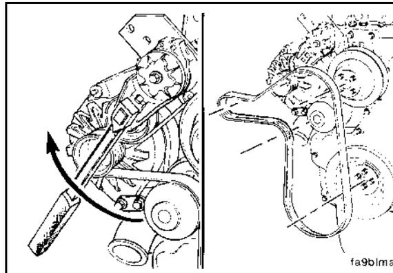
**FIGURE 46. REMOVE THE DRIVE BELT**
