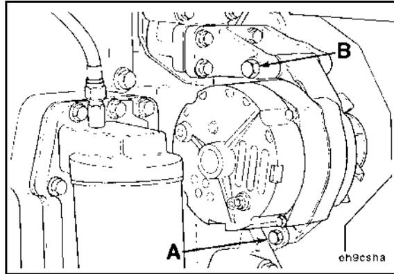
**FIGURE 74. INSTALL THE ALTERNATOR**
