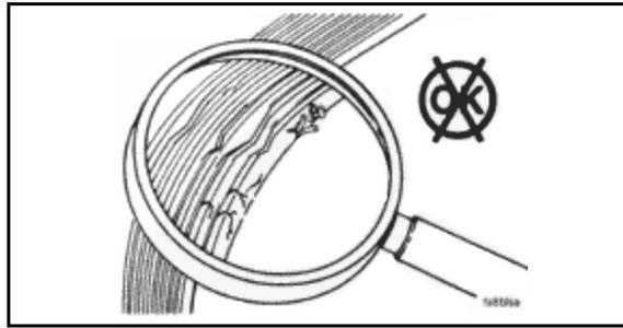
FIGURE 5. INSPECT THE DRIVE BELT
