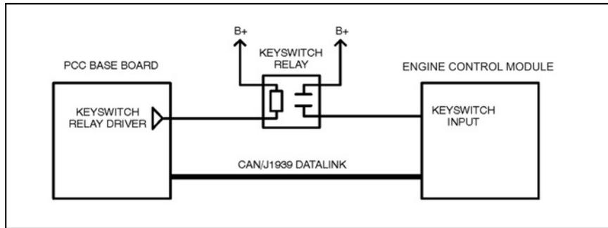
FIGURE 21. CONTROL SYSTEM BLOCK DIAGRAM
