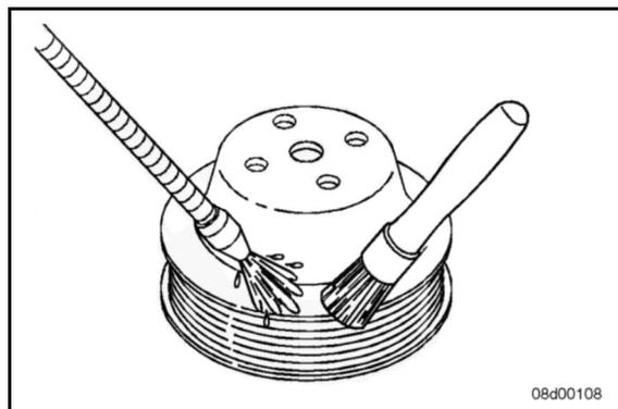
**FIGURE 12. CLEAN THE FAN PULLEY**
