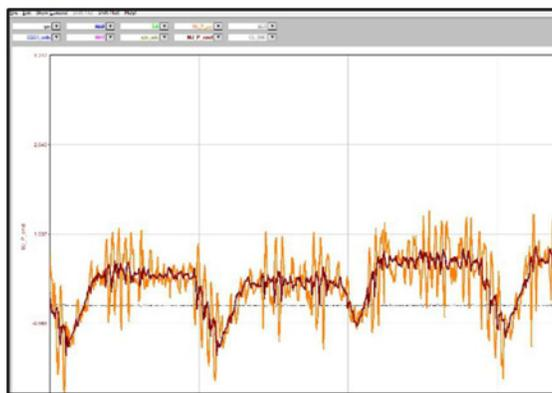
**FIGURE 79. POOR FUEL CONTROL EXAMPLE**
