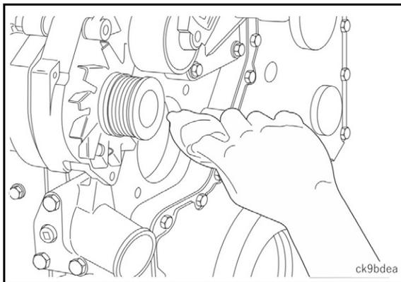
**FIGURE 48. CLEAN THE CYLINDER BLOCK SEALING SURFACE**
