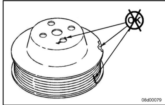
**FIGURE 13. INSPECT THE FAN PULLEY**
