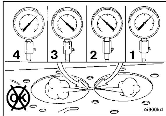
FIGURE 89. LEAKS BETWEEN THE CYLINDERS
