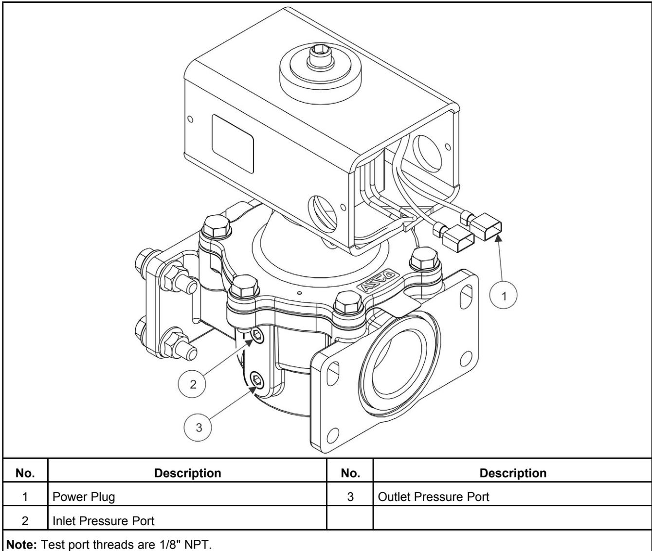
**FIGURE 40. FUEL SHUTOFF SOLENOID VALVE**
