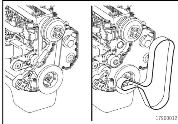
**FIGURE 50. INSTALL THE BELT**
