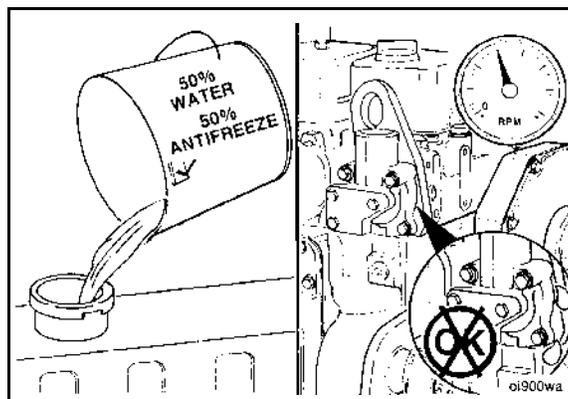
**FIGURE 76. FILL THE COOLING SYSTEM**
