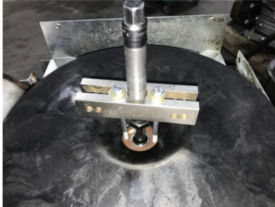
**FIGURE 64. PULLING FAN HUB OFF ROTOR**
